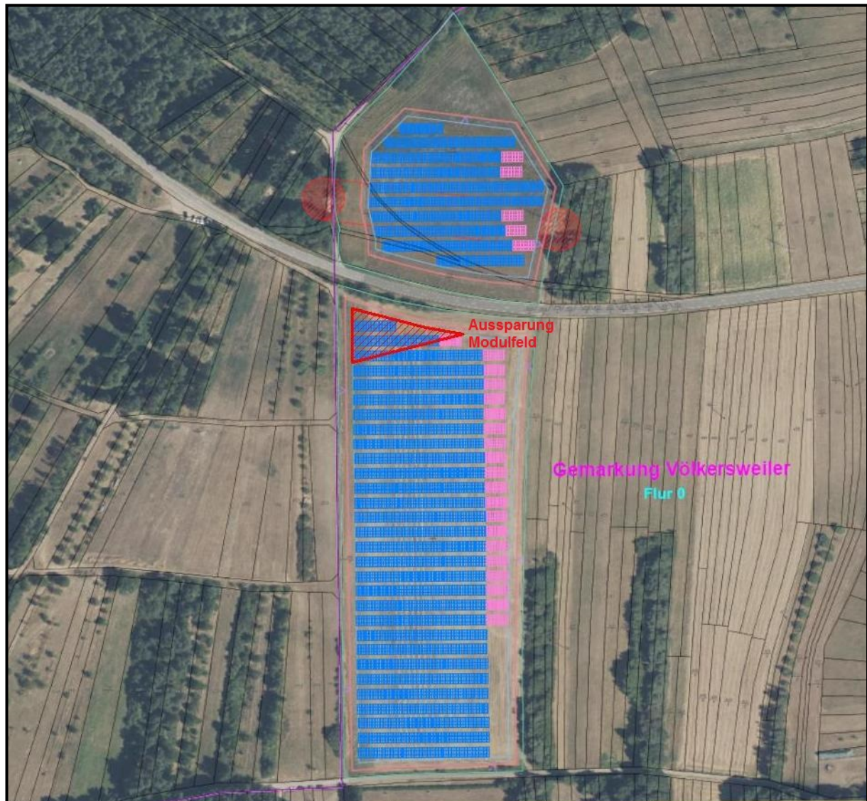
Abbildung 8: Empfohlene Maßnahme zum Blendschutz auf der Landstraße L 495: Aussparung des blendungsrelevanten Modulfeldes im Südteil der PVA (ca. 1.500 m 2 ).
