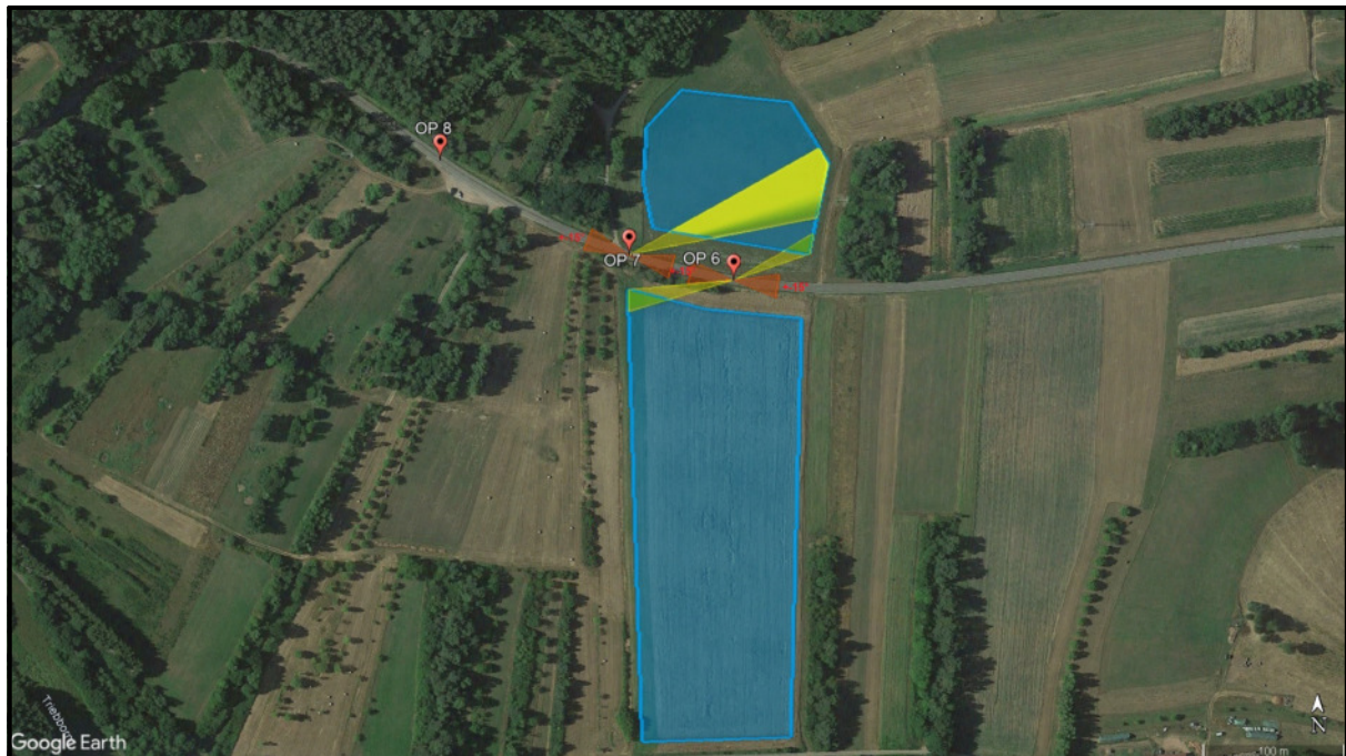
Abbildung 7: Blendungsmöglichkeiten des Fahrzeugführers an den Immissionsorten OP 6-7 (Landstraße L 495) bei Vorbeifahrt in West- bzw. Ostrichtung. Rote Bereiche: relevante Blickwinkel ( \pm 15^\circ ) des Fahrzeugführers. Gelbe Bereiche: immissionsortspezifische Blendwinkel des Modulfeldes.
