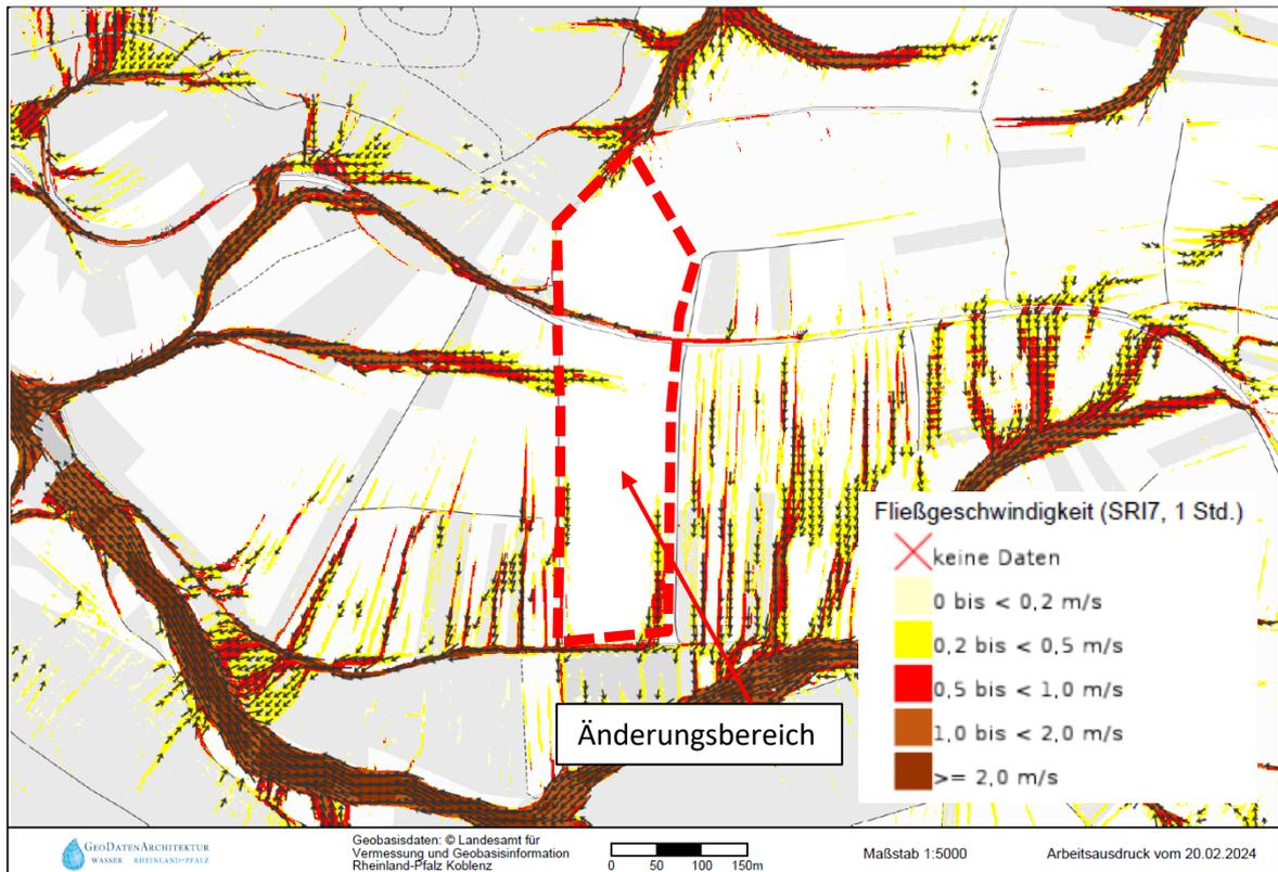
Abbildung 11: Fließgeschwindigkeiten nach einem extremen Starkregenereignis, 1 Std. (© Landesamt für Vermessung und Geobasisinformation Rheinland-Pfalz Koblenz)
