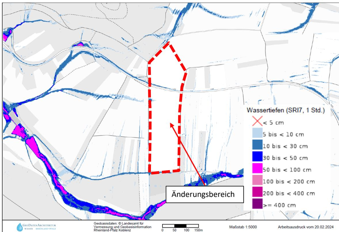
Abbildung 8: Wassertiefen nach einem außergewöhnlichen Starkregenereignis, 1 Std. (© Landesamt für Vermessung und Geobasisinformation Rheinland-Pfalz Koblenz)
